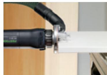
Zaoblování hran materiálu z plastu nebo z masivního dřeva.
