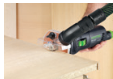
Lícovací frézování náklíčků z plastu nebo z masivního dřeva.
